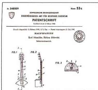
Brevet d'invention N° 248509, déposé en Suisse au nom de K. Schneider. Barre de renfort pour instruments à cordes - 1948.
